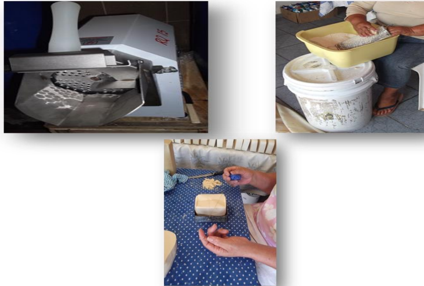
Figura 1 - Ralador de queijo e de cozinha, utilizado pelas sócias para confeccionar o sabão em pó, e cortador de sabão denominado 'CHAPINHA' e fio de nylon.
