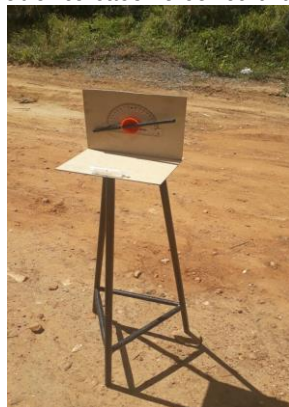
Imagem 2: Teodolito caseiro construído pelos alunos
